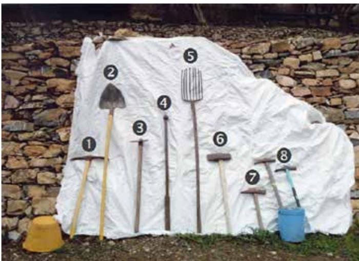
Fig. 1. Attrezzi: 1. piccone; 2. pala; 3. magaglio; 4. palanchino; 5. forcone; 6. mazza; 7. mazzetta; 8. martello.
