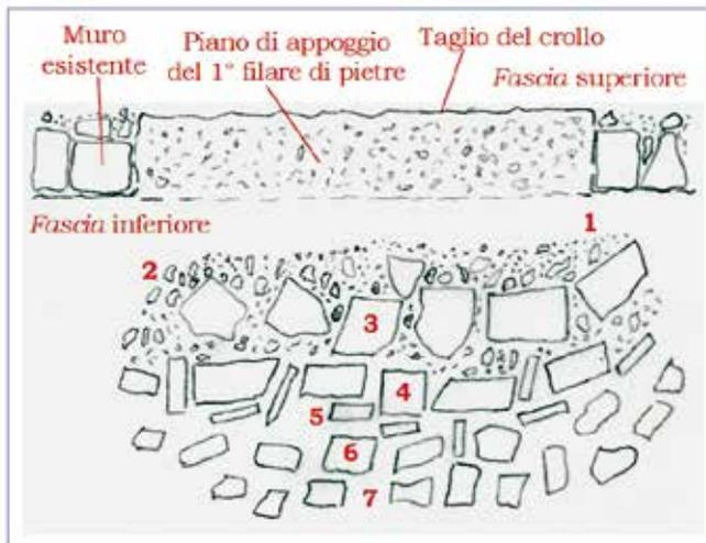
Fig. 3. Schizzo planimetrico che illustra il posizionamento del materiale rimosso dal crollo del muro: 1. terra; 2. pietrisco; 3. pietre grosse (bàusi, 30-300 Kg) per la base (1° filare) del muro; 4. pietre grosse (lastre, 20-80 Kg) per il filare superiore; 5. pietre appiattite per livellare (scianaseue); 6. pietre di dimensioni inferiori (10-30 Kg) per "murare"; 7. pietre irregolari (5-30 Kg) per "murare" o da spaccare (individuando il "filo", fi da prea, per lo spacco: vd. anche fig. 9).
